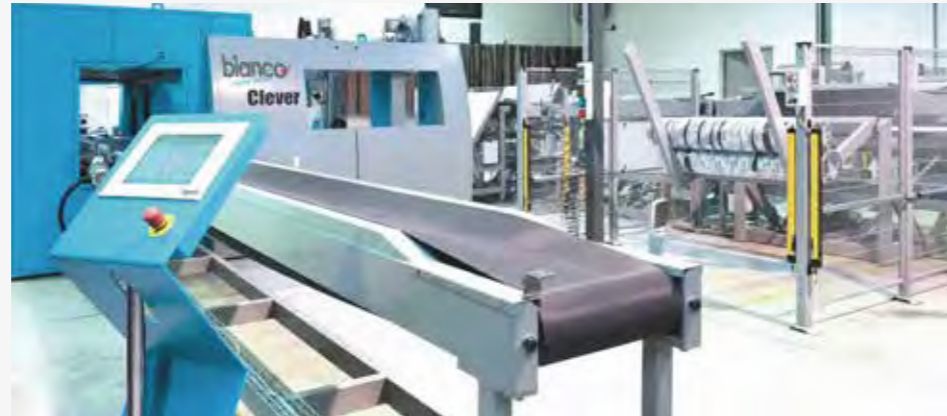
Machine infeed with conveyor belt capable of 200kg weight Ingresso macchina con nastro portata 200kg
