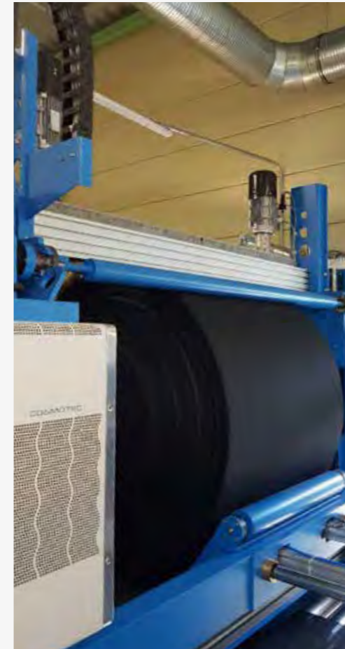
Infeed fabric winder Avvolgitore ingresso tessuto
