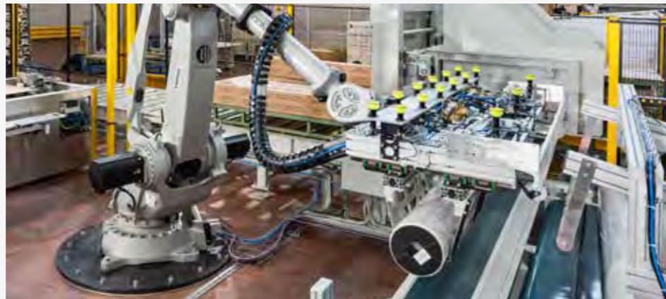
Roll pick up Presa rotolo
