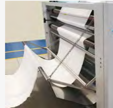
Fabric infeed from scray Ingresso tessuto da scivola
