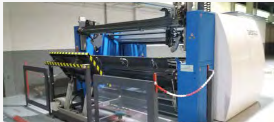
Exit on basket with tilting device Uscita su ribaltina e cesta
