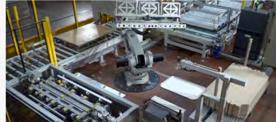
Carton cutout pick up Presa cartonato steso
