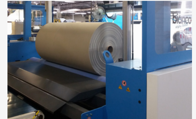
Winding station exit Uscita stazione di avvolgimento
