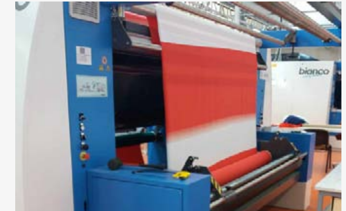
Fabric feed via motorised small roll Ingresso tessuto tramite piccolo rotolo motorizzato
