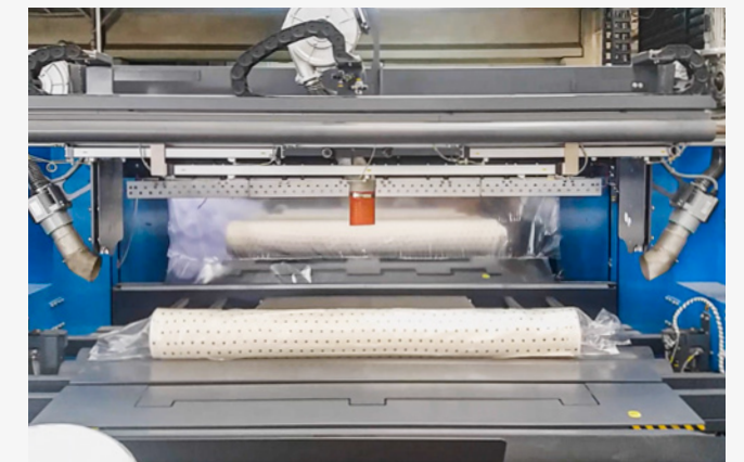
Central hot air sealing and shrink wrapping Fonatura centrale e chiusura a ghigliottina
