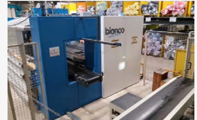
Rolls infeed via rotating conveyor belt Ingresso rotoli in macchina tramite nastro rotante
