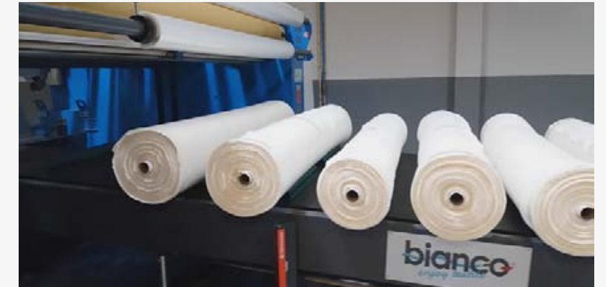
Motorised accumulation table Tavolo d'accumulo motorizzato
