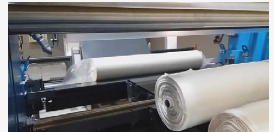
Side roll hot air sealing Fonatura laterale rotolo
