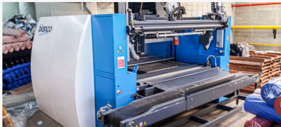
Exit on conveyor belts Uscita su nastro
