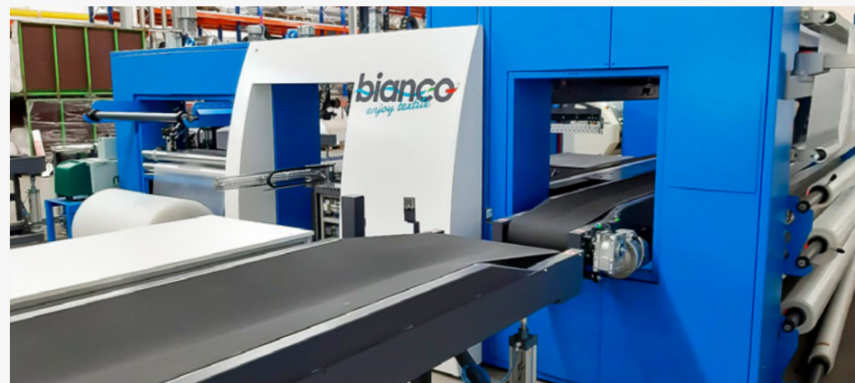
Roll feed via conveyor belts Ingresso rotoli da linea nastri
