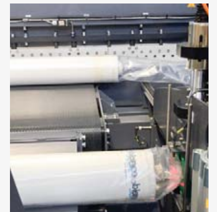
Ultrasonic sealed roll Rotolo chiuso ad ultrasuoni
