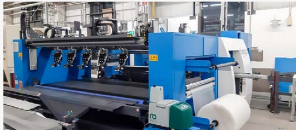
Rolls exit with conveyor belts and pluriball packing station Uscita rotoli con linea nastri e stazione di imballo Pluriball
